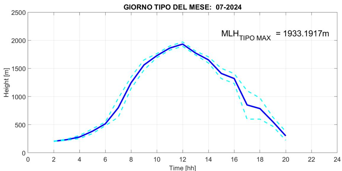
**Fig. 2: Giorno tipo del parametro Mixing Layer Height nel mese di LUGLIO 2024, rappresentato mediante media oraria (linea blu continua) e deviazione standard (linee celesti tratteggiate).**
