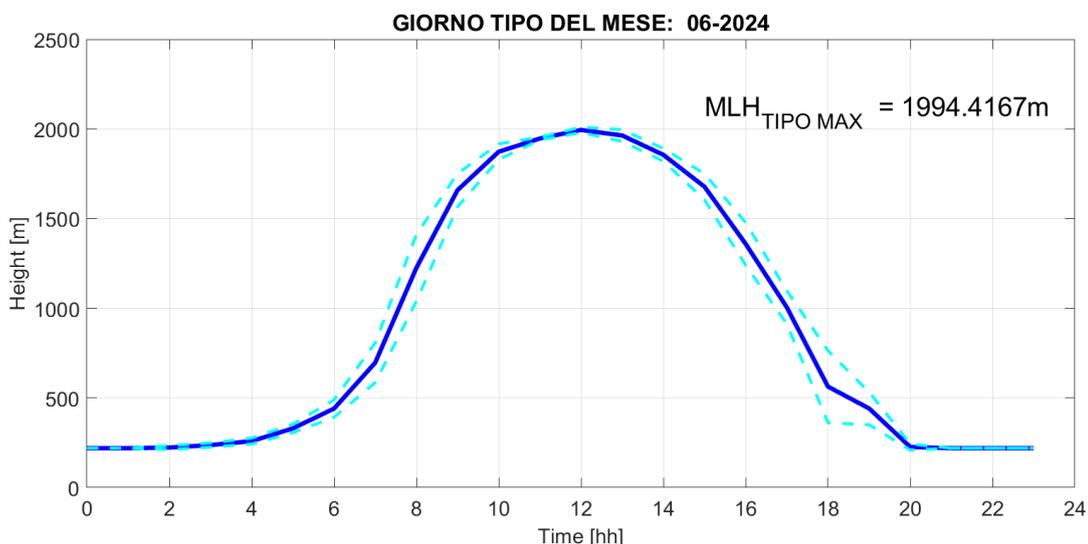
Fig. 2: Giorno tipo del parametro Mixing Layer Height nel mese di GIUGNO 2024, rappresentato mediante media oraria (linea blu continua) e deviazione standard (linee celesti tratteggiate).
