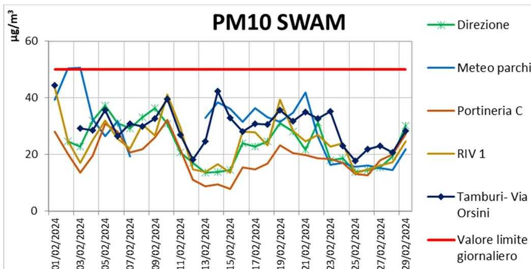
**Figura 10 - Livelli di concentrazione Febbraio 2024 di PM10 (SWAM) in  $\mu\text{g}/\text{m}^3$  (Rete AdI senza Cokeria)**
