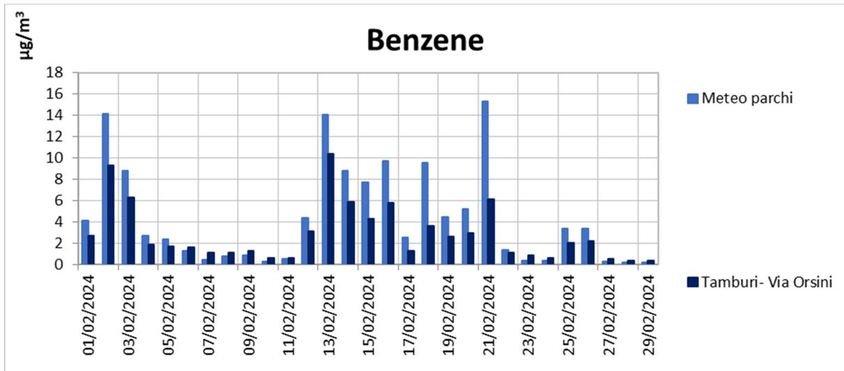
Figura 24 - Confronto livelli di concentrazione di Benzene in  $\mu\text{g}/\text{m}^3$
