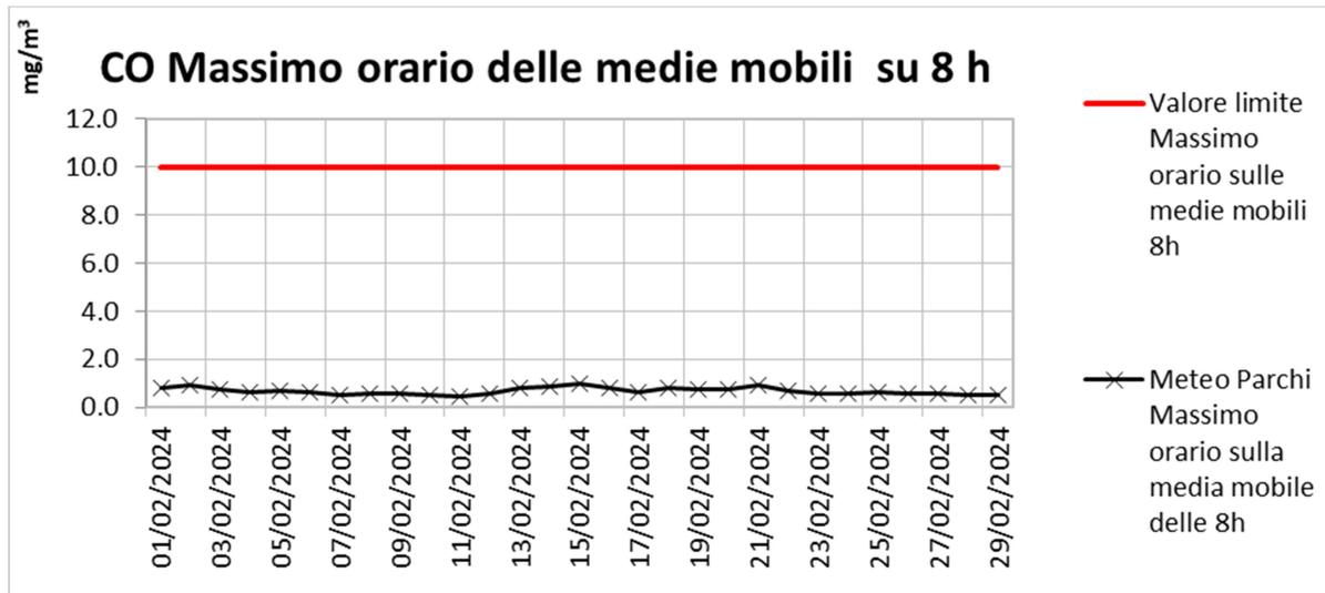
Figura 46 - Livelli di concentrazione di CO in mg/m<sup>3</sup>
