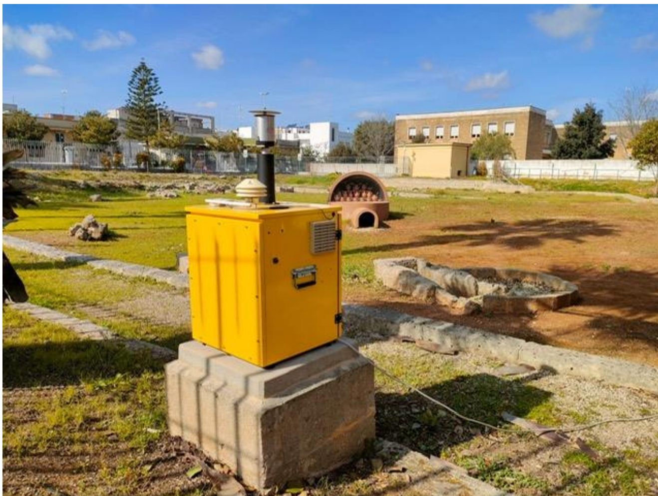
Figura 2: Campionatore sequenziale Lifetek PMS installato nel sito di monitoraggio di Oria (BR).
