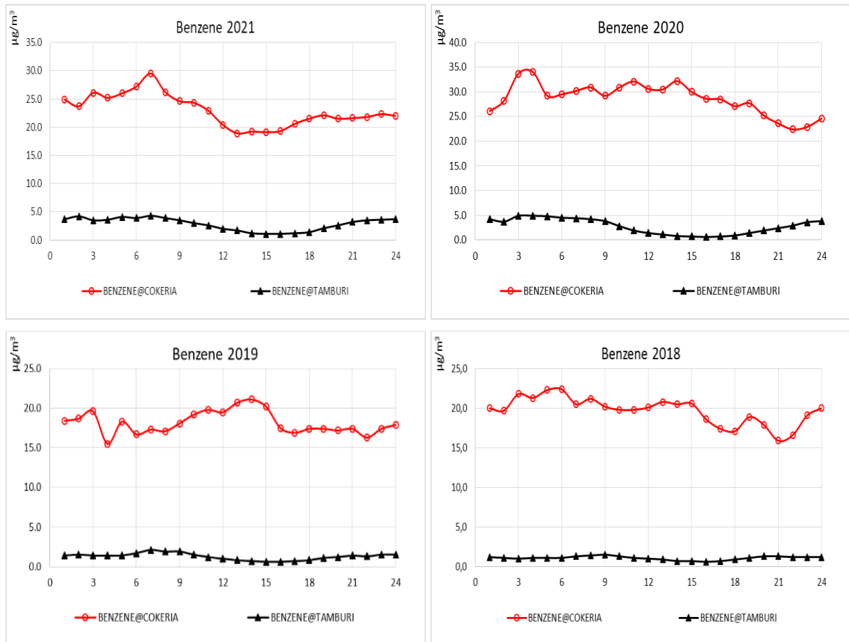
Fig. 8c - Giorni tipo delle concentrazioni di Benzene a Tamburi-Via Orsini e Cokeria in \mu\text{g}/\text{m}^3 , Periodo 2018 ÷ 2021
