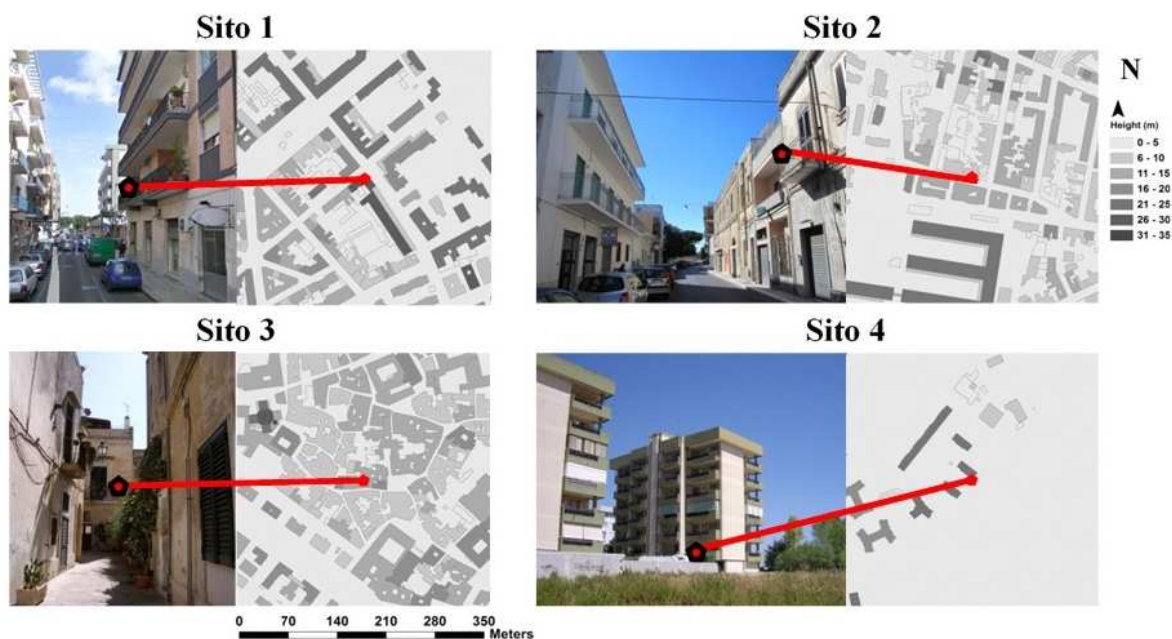
Figura 3 Foto aerea della città di Lecce (in alto) con indicazione delle stazioni di rilevamento della temperatura atmosferica. Foto aerea (al centro) dei quattro siti osservati e indicazione (in basso) del posizionamento dei termometri e del DEM (Digital Elevation Model).
