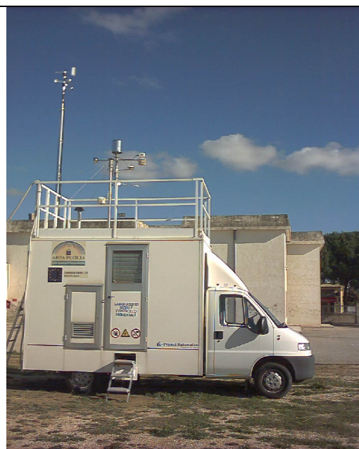
Figura 3.2: Laboratorio mobile collocato presso la Torre S. Susanna
