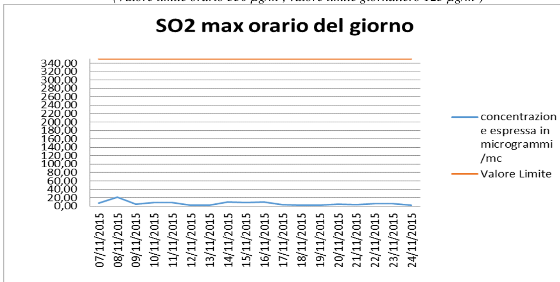
Figura 3: Andamento della concentrazione massima oraria espressa in \mu\text{g}/\text{m}^3 (Valore limite orario 350 \mu\text{g}/\text{m}^3 , valore limite giornaliero 125 \mu\text{g}/\text{m}^3 )
