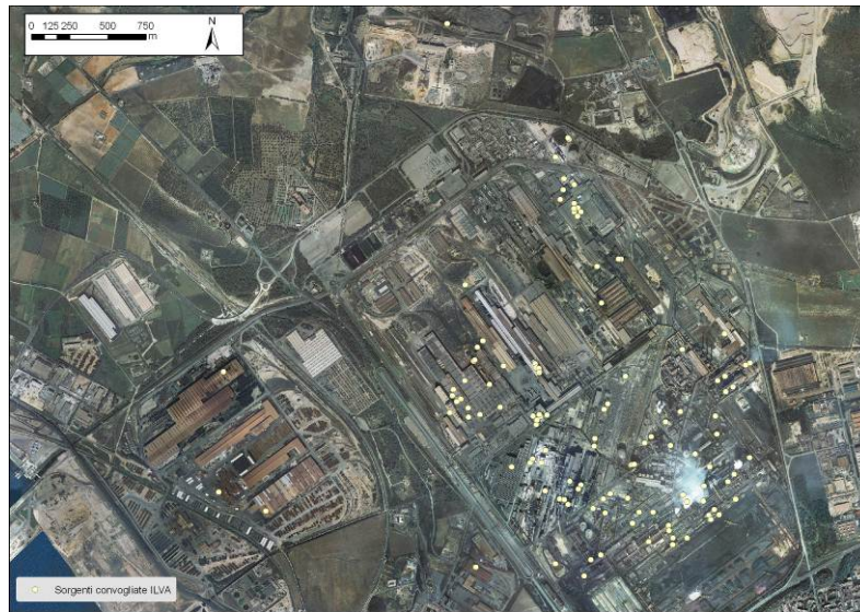
Fig.15 Localizzazione delle sorgenti puntuali simulate, presenti all'interno dello stabilimento ILVA di Taranto (punti gialli)
