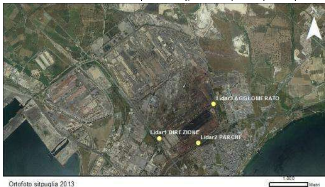
Fig. 1: Posizionamento dei tre sistemi LIDAR posti lungo il perimetro dello stabilimento industriale ArcelorMittal Italia.
