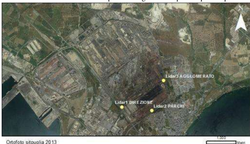
Fig. 1: Posizionamento dei tre sistemi LIDAR posti lungo il perimetro dello stabilimento industriale ArcelorMittal.
