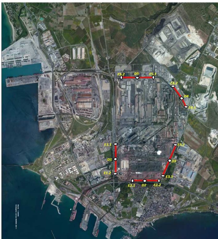
ALLEGATO: POSIZIONAMENTO SISTEMI DOAS "FENCE MONITORING"
