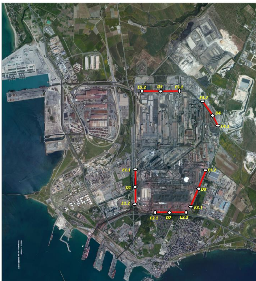
ALLEGATO: POSIZIONAMENTO SISTEMI DOAS "FENCE MONITORING"
