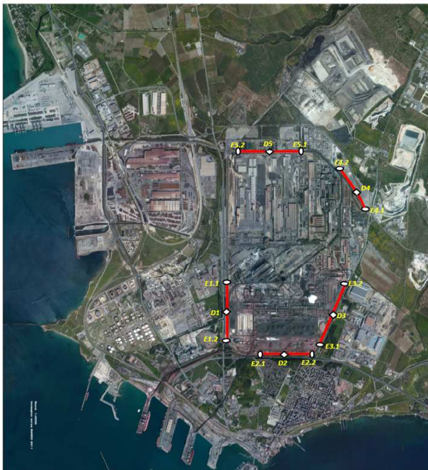
ALLEGATO: POSIZIONAMENTO SISTEMI DOAS "FENCE MONITORING"
