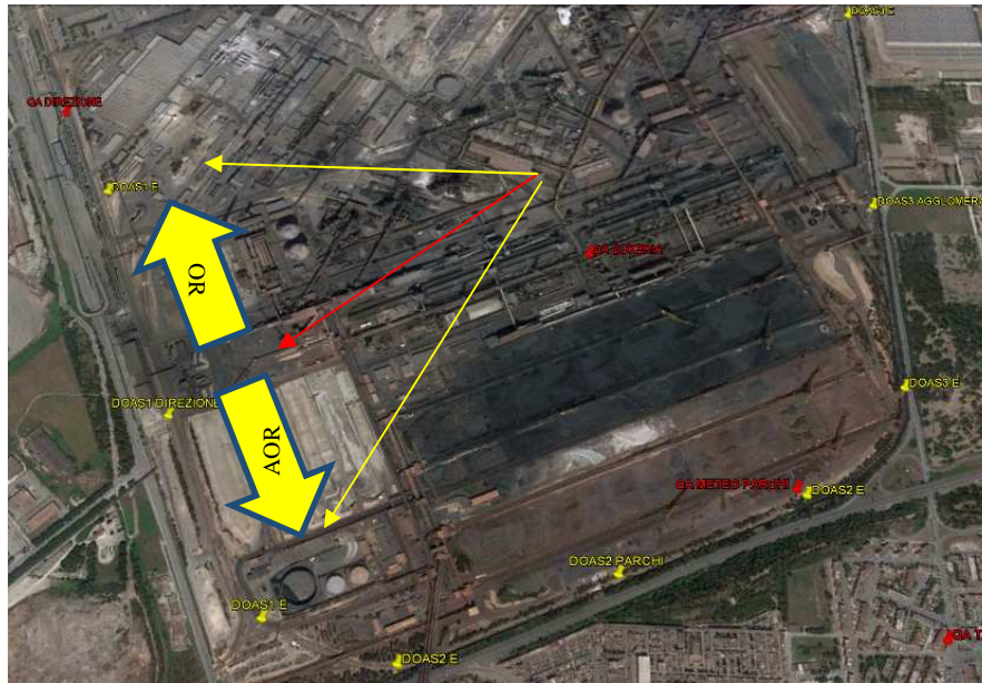
Fig.2 – Identificazione dei percorsi ottici
