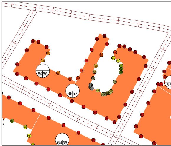
Figura 3.4 – Visualizzazione dei ricettori in facciata edificio e ricostruzione 3D
