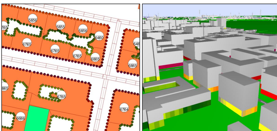
Figura 4.4 – Visualizzazione dei ricettori in facciata edificio e ricostruzione 3D
