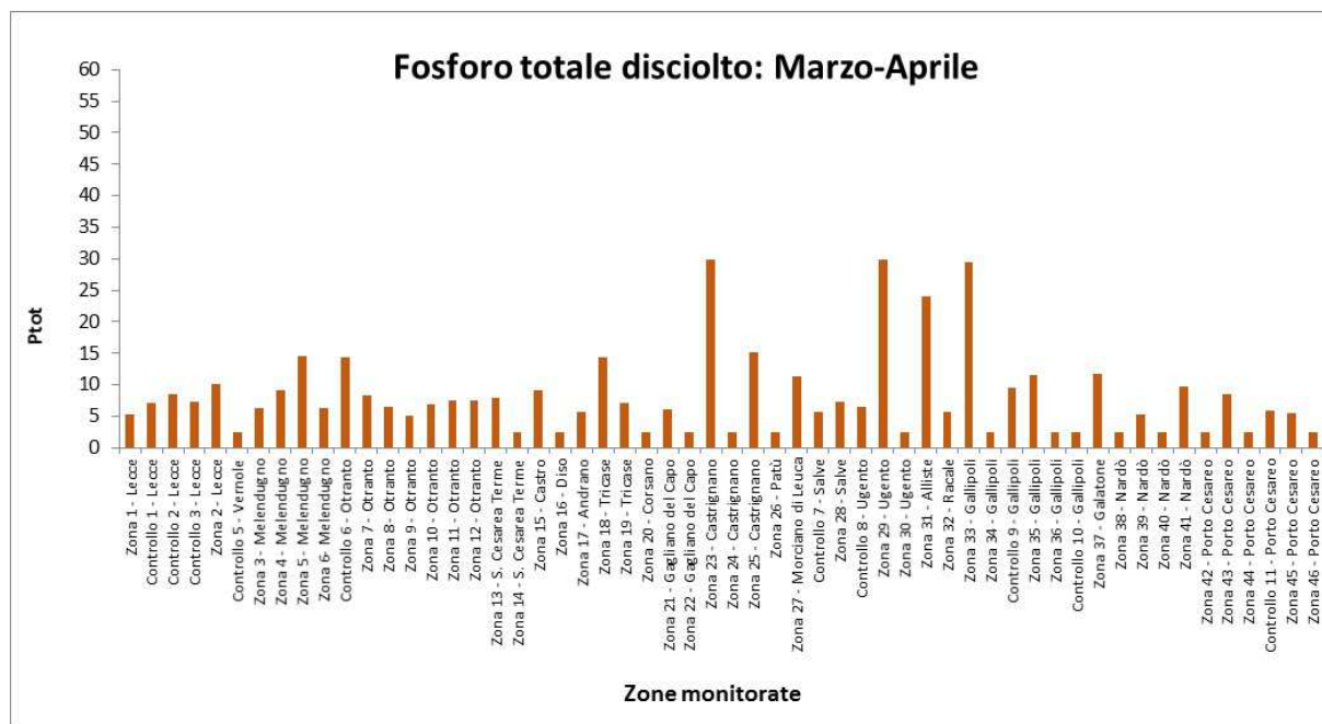
Fig. 17. Valori della concentrazione del Fosforo totale ( \mu\text{g/l} ) nella stagione primaverile.
