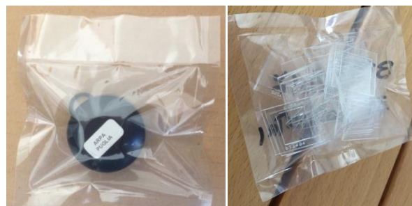
Figura 1b. CR-39 in busta impermeabile al radon.
